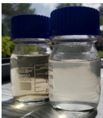
Ryc. 3. Wizualne przedstawienie efektów działania preparatu RemLake. Fotografia przedstawia próbę kontrolną (lewa strona) oraz próbę z preparatem RemLake po 48h po aplikacji (prawa strona)
